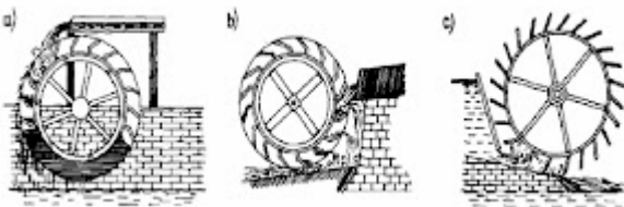
Rys.3 Koło wodne o wale poziomym : a) nasiębierne b) śródsiębierne c) podsiębierne[12].
